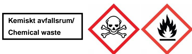
Figur 7: Rekommenderad uppmärkning av avfallsrum där kemiskt avfall förvaras.
